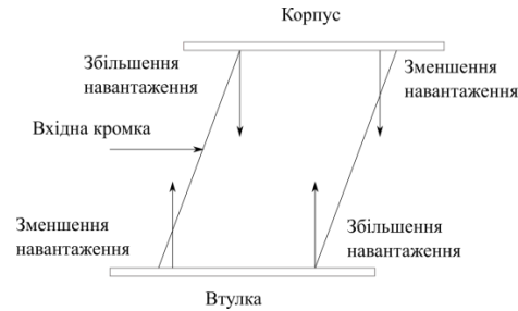
Рисунок 1. Вплив стріловидності на навантаження лопатки
