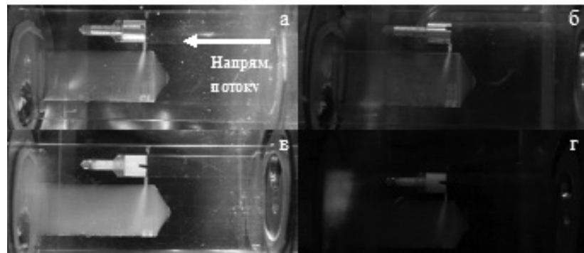
Рисунок 2 — Результати досліджень впливу матеріалу гвинта на інтенсивність люменесценції, що виникає в каналі дроселюючого елемента: а, б — алюміній, в, г — фторопласт.
