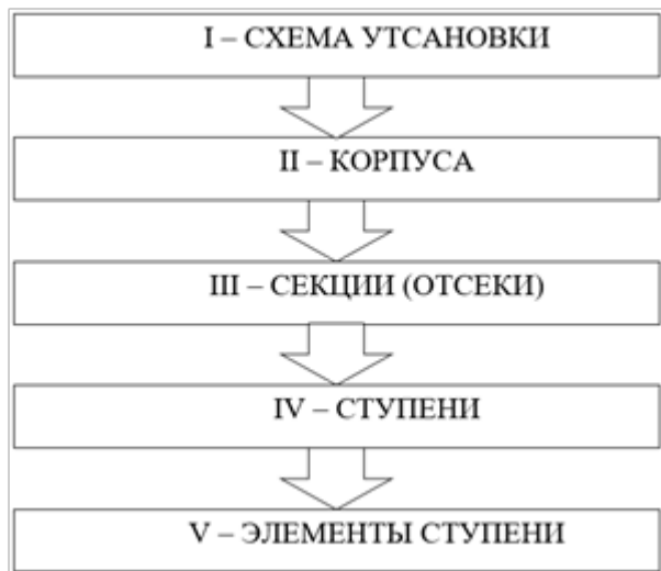
Рисунок 1 – Схема иерархии уровней технических систем
