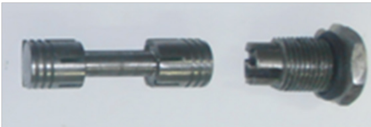
Рисунок 2 – Золотниковий елемент доопрацьованої конструкції роздільника потоку вивантажувача стеблового корму
