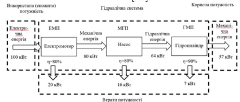
Рисунок 1 – Спрощена структура гідравлічної системи
