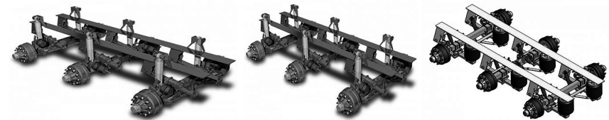
Рисунок 2 – Активні підвіски: гідропневматичні, гідравлічні, пневматичні
